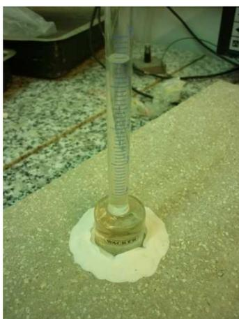
**PLACAS DE HORMIGÓN** fabricadas con cemento Portland CEM 42,5 R, áridos, finos y agua en proporciones y metodología según especificaciones de la **Norma Europea UNE-EN 1323:2007**.
