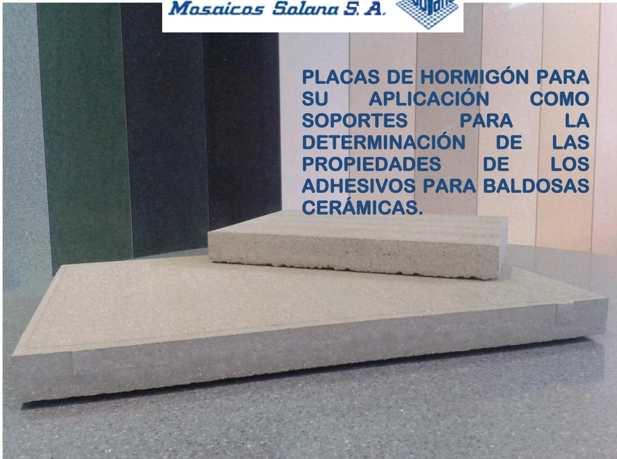
**PLACAS DE HORMIGÓN PARA SU APLICACIÓN COMO SOPORTES PARA LA DETERMINACIÓN DE LAS PROPIEDADES DE LOS ADHESIVOS PARA BALDOSAS CERÁMICAS.**
